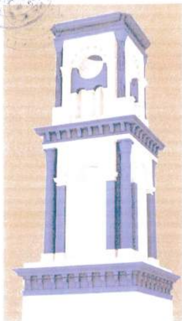
εικ. 7-2 : Τμήματι Καθισματοσπίλων που προτείνεται να καθαιρεθούν και να ανακατασκευαστούν επανηχοηρηματούμεντοις, τικος λήθικας και τα λήθικα μέλη που κρίνονται υγιή.
