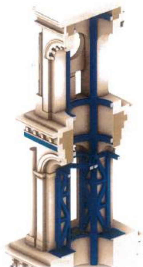
εικ. 7-3 : Μεταλλικός φορέας εντός του 4 ου και 5 ου επιπέδου των Καθισματοσπίλων.
